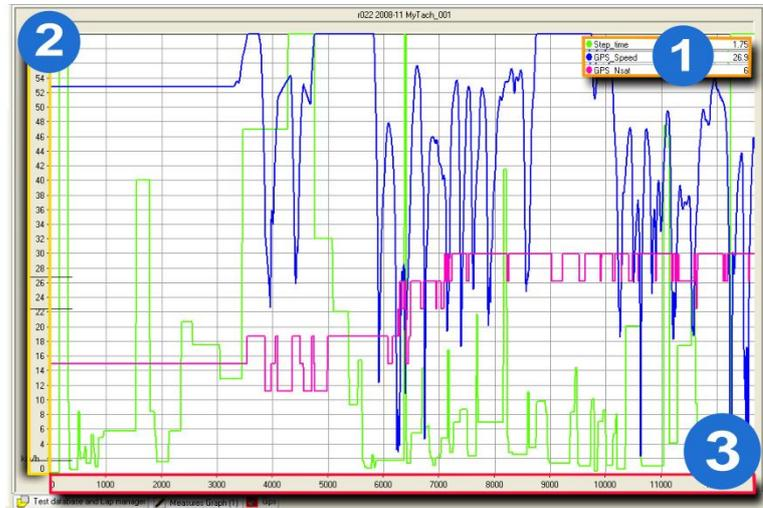
La funzione “grafico misure” permette di visualizzare i valori puntuali per tutti i canali acquisiti – selezionabili nell’area 1 – in ogni punto del tracciato.
