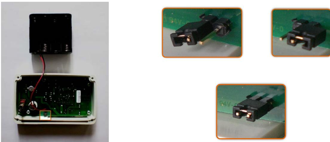
Le immagini sopra a destra mostrano le possibili opzioni di funzionamento. Quando lo si acquista il trasmettitore è impostato su low power mode: immagini di destra in alto. Per impostare il funzionamento high power inserire entrambe le clip nel ponticello come mostrato nella foto di destra in basso.
