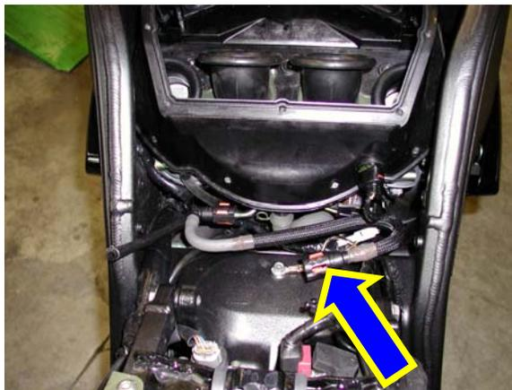
**Figura 18:** il tubo del carburante
