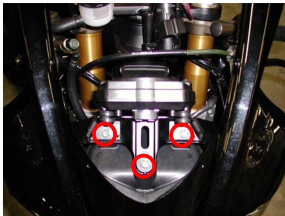
**Figura 5:** Le viti che fissano il cruscotto di serie ad un telaio interno.
