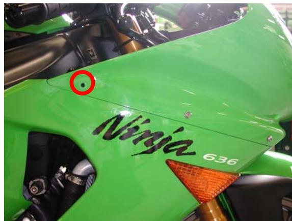
**Figura 2:** .Vite laterale da rimuovere.
