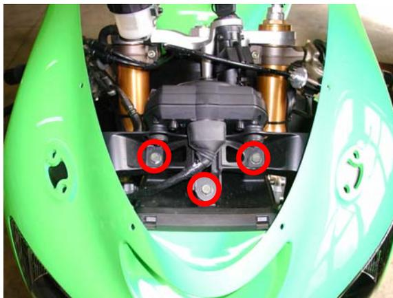
**Figura 4:** posizione delle viti del telaio interno.
