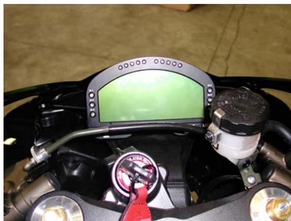
Figura 10: MXL correttamente installato.
