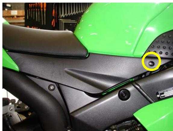
Figure 12: vite del telaietto di plastica di destra.
