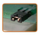
Le immagini sopra a destra mostrano le possibili opzioni di funzionamento. Quando lo si acquista il trasmettitore è impostato su low power mode: immagini di destra in alto. Per impostare il funzionamento high power inserire entrambe le clip nel ponticello come mostrato nella foto di destra in basso.
