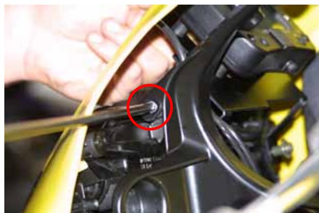
Figura 30: fissaggio delle viti laterali.
