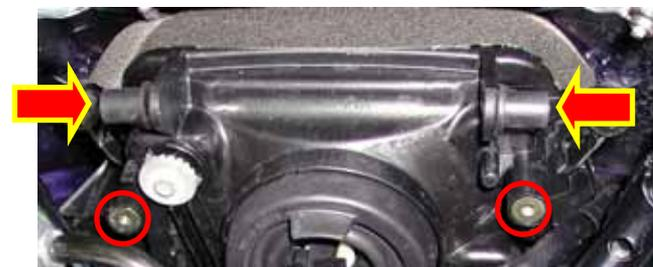
Figura 29: posizione delle quattro viti.
