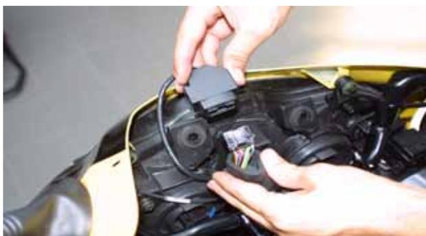
**Figura 26:** Installazione cablaggi particolare del connettore AMP
