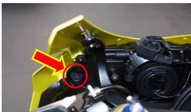
Figura 12: posizione delle viti della carenatura e del faro anteriore
