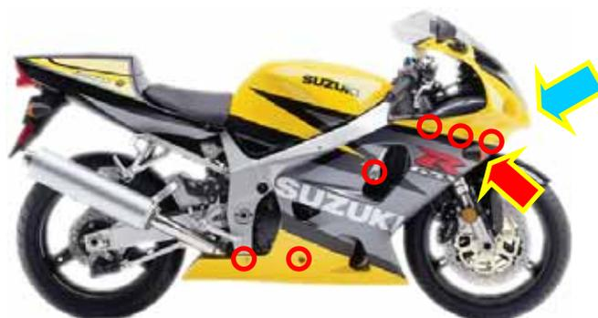
**Figura 4:** Carenatura laterale destra posizione delle viti e delle spine.
