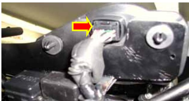
**Figura 16:** Sganciamento del connettore del cruscotto di bordo.
