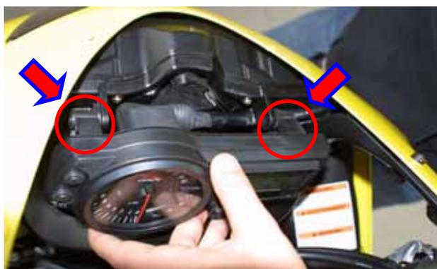
**Figura 15:** rimozione del cruscotto di serie
