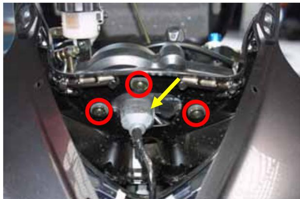
**Figura 19:** Posizione delle viti del cruscotto di serie.
