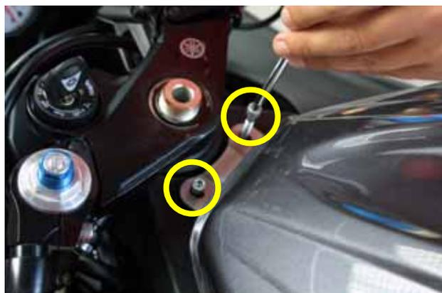
Figura 2: rimozione delle viti del serbatoio.
