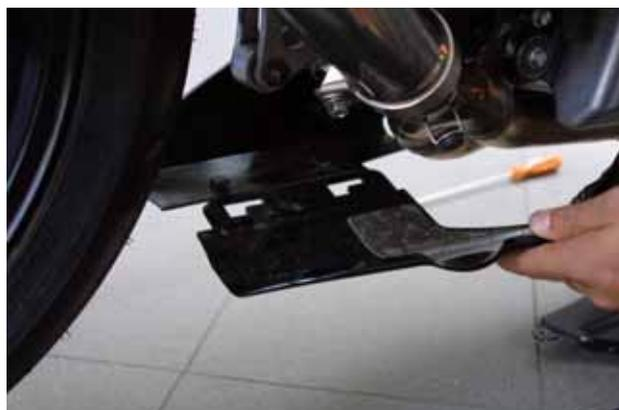
**Figura 12:** Allargare le giunzioni delle carene laterali
