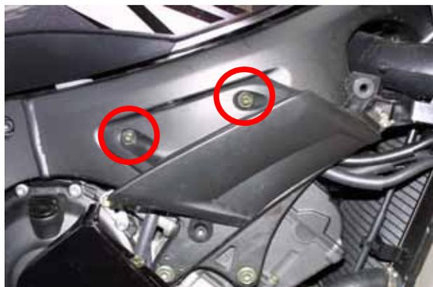
**Figura 13:** posizione delle viti del telaio protettivo.
