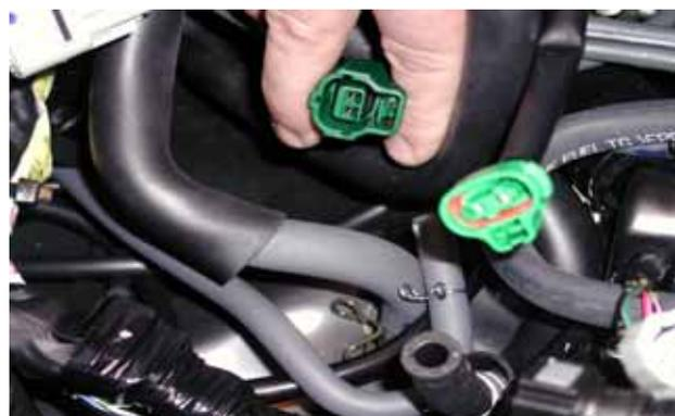
**Figura 25:** il connettore temperatura acqua di bordo
