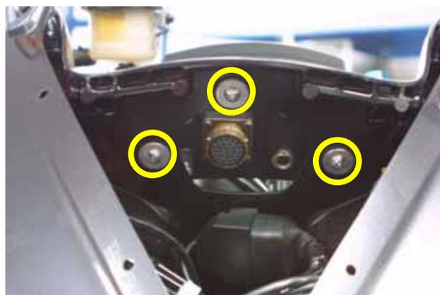
Figura 28: MyChron 3 correttamente installato (vista posteriore)
