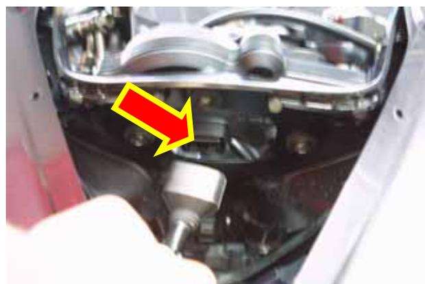
**Figura 18:** scollegare il connettore del cruscotto di serie
