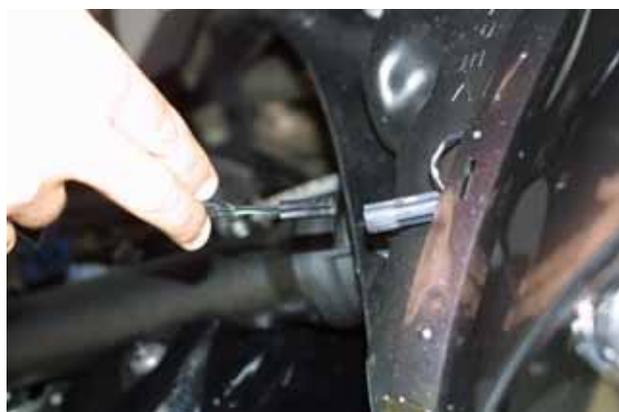
**Figura 14:** il connettore delle frecce.
