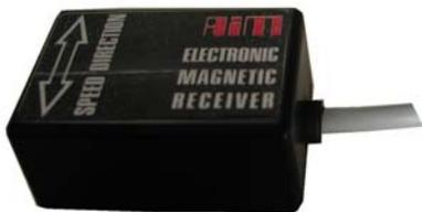
**Il ricevitore magnetico** deve essere installato sul fondo del kart, con due fasce elastiche. Le frecce del ricevitore magnetico devono puntare rispettivamente verso la parte anteriore e posteriore del kart.
