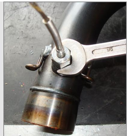
**Attenzione:** nel far correre il cavo della termocoppia lungo il telaio tenerlo il più lontano possibile da altri cavi (come il cavo RPM o quello del ricevitore di giro) per minimizzare eventuali interferenze.
