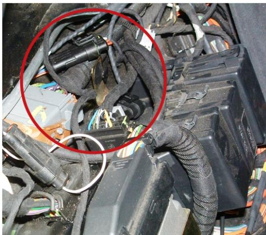
E' consigliato alimentare il sistema connettendosi alle terminazioni poste sotto il pannello dello stacca-batteria. Nelle immagini sotto è mostrato il pannello sul quale è posto lo stacca-batteria, ed i cavi dell' alimentazione così come si presenteranno una volta smontata la copertura.
